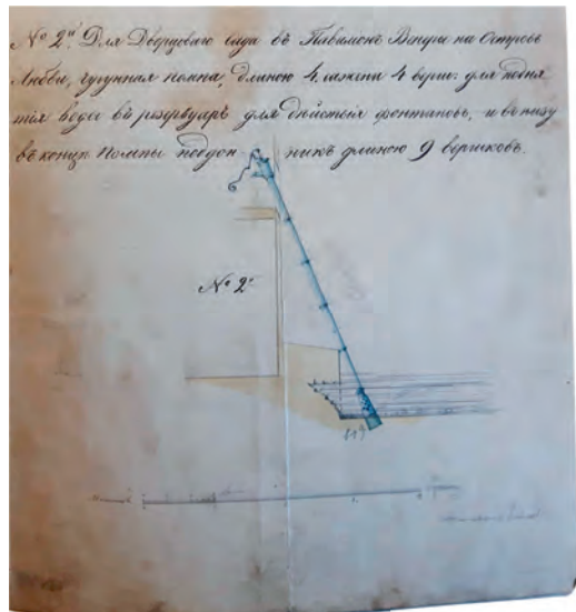
Илл. 4. Чугунная помпа для поднятия воды в резервуар для действия фонтанов Павильона Венеры. Архитектор А. М. Байков. РГИА, Ф. 491. Оп. 2. Д. 396. Л. 1
